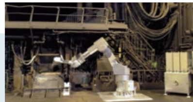
サンプリングロボット(温度測定やサンプル採取を自動化)
